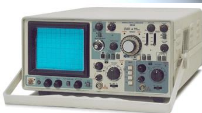
รูปที่ 2-13 เครื่องวัดไฟฟ้าแบบตั้งโต๊ะ (เครื่องวัดรูปคลื่นสัญญาณไฟฟ้า)
